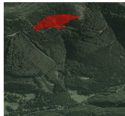
Obr. 4: Identifikácia odtrhovej zóny na svahu s vysokým potenciálom pre vznik lavín a zadávanie výšky odtrhu v prostredí modelu RAMMS.
